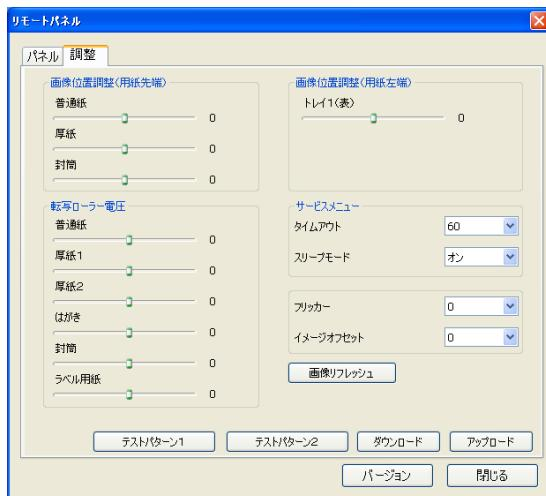
**画面位置調整（用紙先端）**: 上下の印字開始位置を微調整できます。
